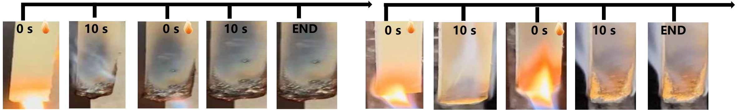
PUA (带火滴落, 引燃, 自熄) 促熔滴作用
